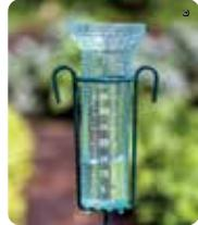
VOCÊ JÁ VIU ESSE OBJETO? TRATA-SE DE UM PLUVIÔMETRO E SERVE PARA MEDIR A QUANTIDADE DE CHUVA. A MEDIDA UTILIZADA POR ESSE APARELHO É EM CENTÍMETROS OU MILÍMETROS.
