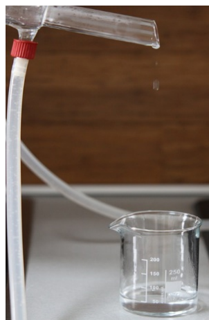
Água sendo coletada em um recipiente no final do processo de separação por destilação simples.
